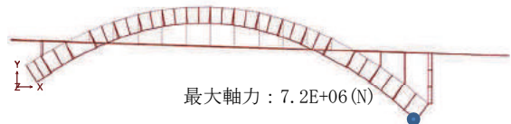
図6 活荷重による軸力
